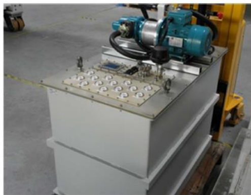
Figure 43 - Cuve modulateur klystron 120 kV (à gauche) & Cuve modulateur 250 kV (à droite)
