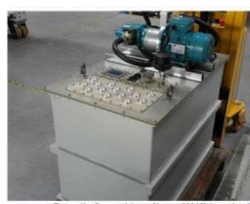
Figure 43 - Cuvie modulateur klystron 120 kV (à gauche) & Cuvie modulateur 250 kV (à droite)
