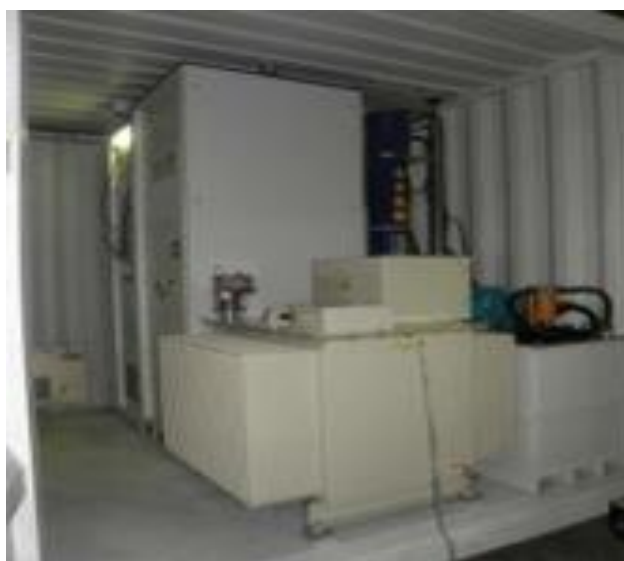
Figure 43 - Cuve modulateur klystron 120 kV (à gauche) & Cuve modulateur 250 kV (à droite)
