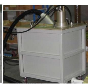
Figure 43 - Cuvie modulateur klystron 120 kV (à gauche) & Cuvie modulateur 250 kV (à droite)
