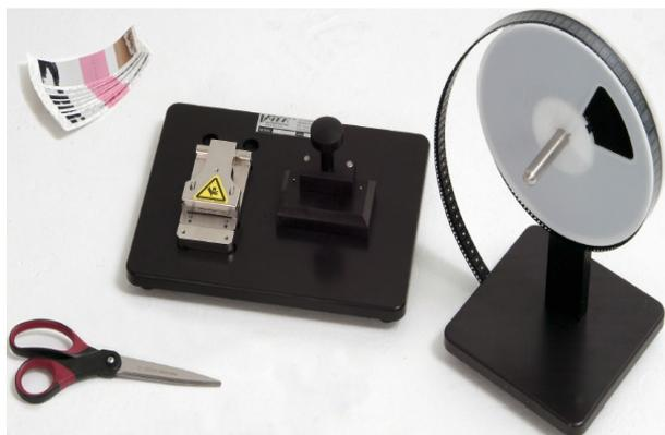
В комплекте поставки находится подставка для катушек, благодаря которой процесс соединения лент получается очень простым. **TS-100** надежное решение для сращивания блистерных лент шириной от 8 - 24 мм, сращивание производится при помощи одного инструмента.
