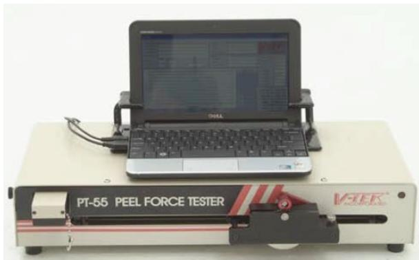
Оборудование предназначено для проведения тестовых испытаний на отрыв. Позволяет определить надежность фиксации компонентов в ячейках блистерной ленты, запечатанной покровной лентой.
