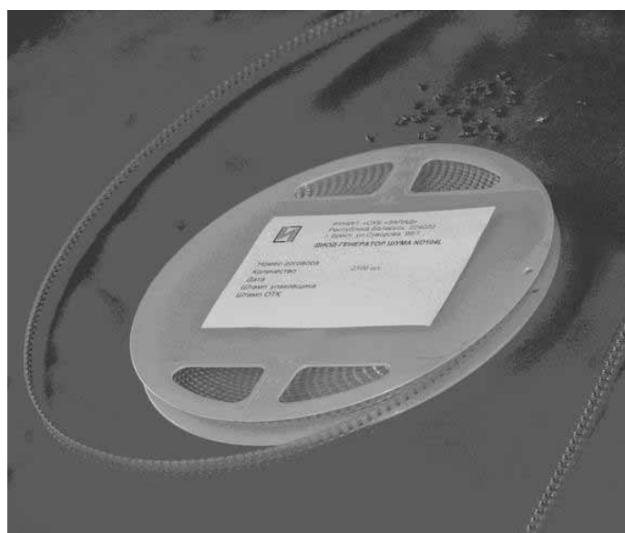
Корпус КД-34 ГОСТ 18472-88 (miniMELF) для поверхностного монтажа
