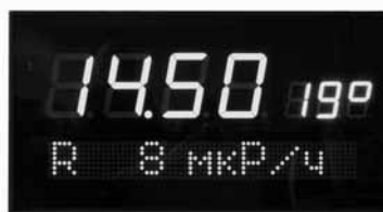
Отображение текущего времени, температуры, уровня радиации.
