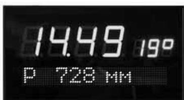
Отображение текущего времени, температуры, атмосферного давления.
